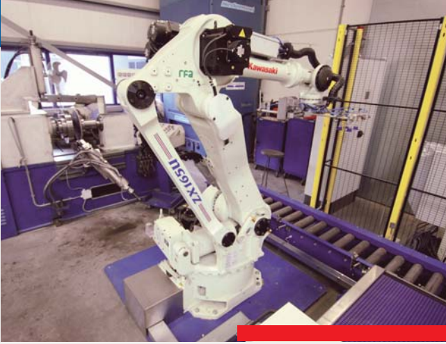
Een volledig geautomatiseerde combinatie van forceerbank met robot en aan- en afvoerlijn
